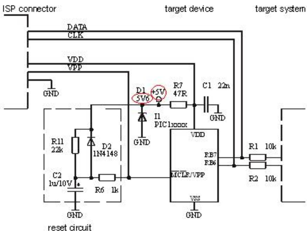
上記の回路設計はISPプログラミングを使った典型的なPICマイコンの回路を示しています。PICマイコンの種類によって多少の違いがあります。例えば、低電圧プログラミング機能を持ったデバイスではPGMピンと呼ばれる1つのエクストラ・ピンを使用します。PIC17C7xxファミリーは2つのエクストラ・ピン-TESTピンとT0CKIピンを使用します。
